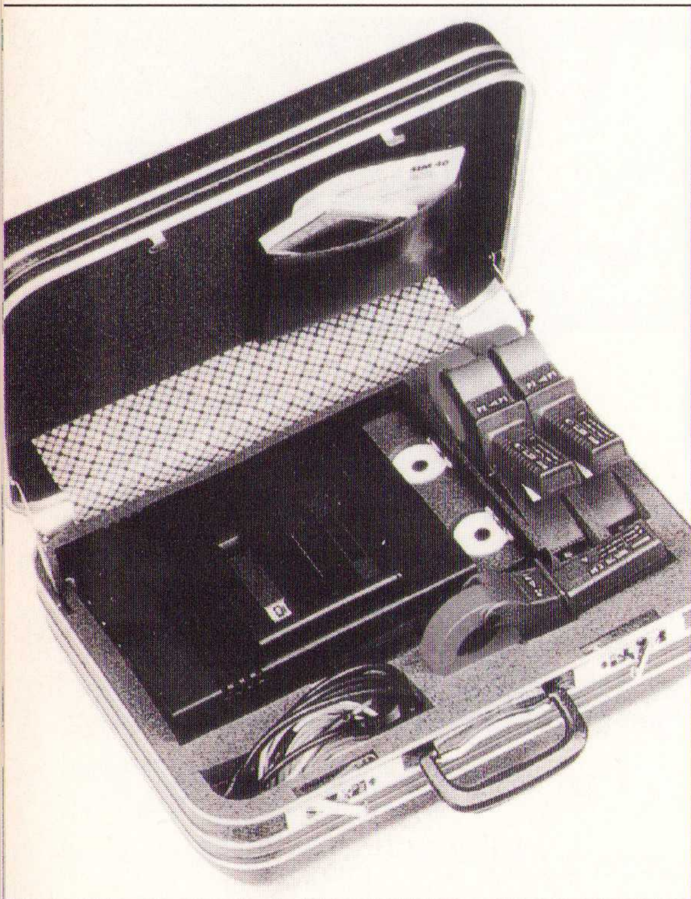
SIM 40: meetsysteem voor elektriciteitsnetwerken.
